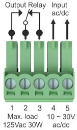
Die DCP Evo verfügt eingangsseitig über einen Optokoppler und einen Schaltausgang (Relais).
