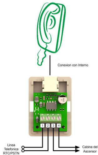
En instalaciones multi-cabina, el MK799 debe instalarse al inicio de la distribución de las líneas hacia las cabinas.
